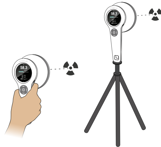
Abbildung 3. Mit der Sensorfläche in Richtung der Strahlenquelle positionieren.
