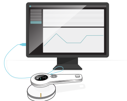
Figura 10. Conecte o instrumento ao RaySafe View.
