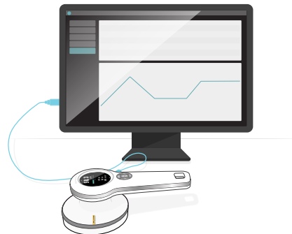
Abbildung 10. Das Gerät mit RaySafe View verbinden.
