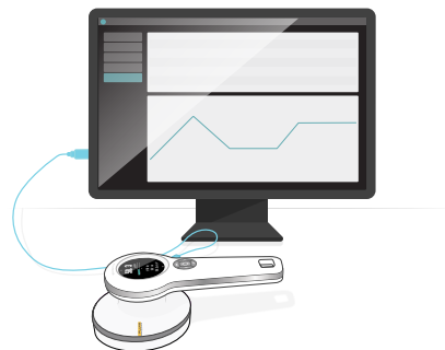
図10. 機器をRaySafe Viewに接続してください。
