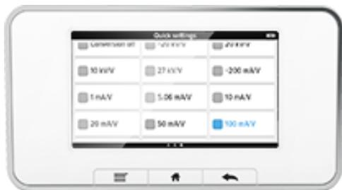
Pour obtenir d'autres paramètres de mesure, en plus de la tension (V) et du temps (s), sélectionnez un facteur de conversion applicable. Faites défiler l'écran d'accueil vers la droite pour accéder aux réglages rapides avec les facteurs de conversion.
