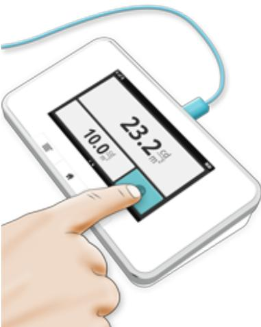
Le capteur mesure constamment. Si vous souhaitez sauvegarder une valeur, appuyez sur le bouton une fois que le relevé est stable. La mesure va continuer en dessous de la valeur sauvegardée.
