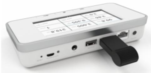
Connectez l'adaptateur Bluetooth à un port de CAPTEUR sur l'unité de base. Un symbole gris d'état de Bluetooth apparaît dans le coin supérieur droit de l'écran.
