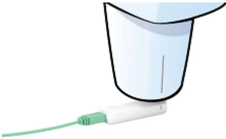
Posez le capteur connecté dans l'axe du champ, avec le réticule tourné vers la source radiologique. Assurez-vous que tout le rectangle du capteur est à l'intérieur du faisceau direct.
