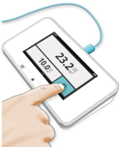
センサーは測定を継続します。数値を保存したい場合は、表示が安定したときにボタンを押します。保存された数値の下では、測定が継続されることにより表示は連続的に更新されます。
