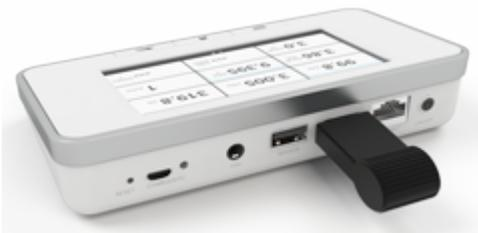
ベースユニットの SENSOR ポートに Bluetooth アダプタを接続します。グレーの Bluetooth ステータスシンボルが、画面の右上に表示されます。
