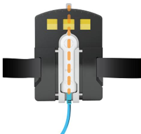
通过居中的 X2 传感器将全景支架固定，使整个传感器矩形位于直接光束以内。
