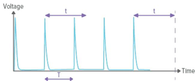
当结束延迟时间长于脉冲间隔 ( $t > T$ ) 时, 数据将记录在同一个测量结果中。注意, 最后一个脉冲结束后, 需要等待设置的结束延迟时间 ( $t$ ) 后, 才会显示测量结果。
