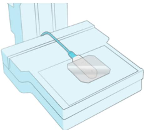
将传感器置中并距离胸壁 6 cm。将 2 mm Al 滤过片放置于传感器上。确保覆盖有效传感器区域。
