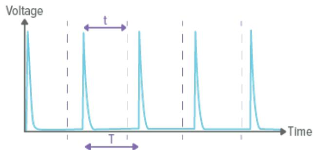
当结束延迟时间短于脉冲间隔 ( $t < T$ ) 时, 数据将会被分别记录在各个测量结果中 (一个脉冲一个结果)。
