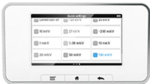
如需获得电压 (V) 和时间 (s) 外的其他测量参数，请选择适用的换算系数。主屏幕右滑访问快速设置中的换算系数。
