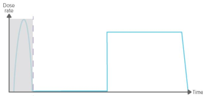
忽略前置脉冲 = 1，(第一个) 前置脉冲得以从测量中排除。
