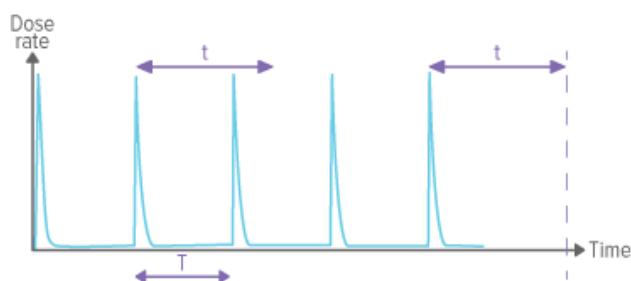
关闭延迟 ( $t$ ) 设置时间比脉冲间隔时间更长 ( $t > T$ )，将产生一次长时间的测量。请注意，您的等待时间必须与测量结束前的最后曝光以后的关闭延迟设置时间 ( $t$ ) 一样长，才能显示值。
