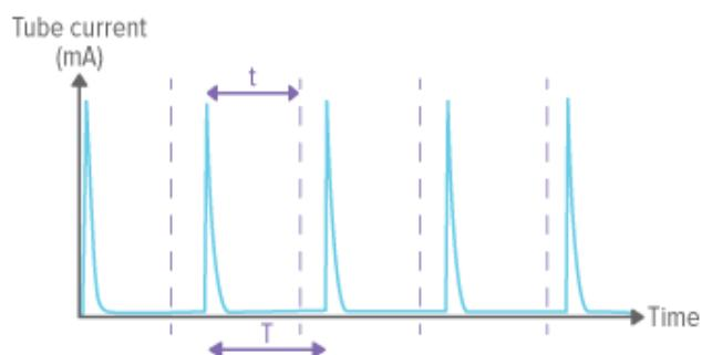
关闭延迟设置比脉冲间隔时间更短 ( $t < T$ )，将导致许多次短时间的测量（一个脉冲一次）。
