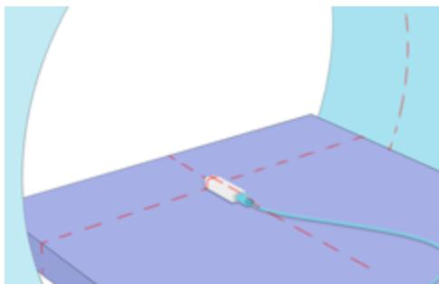
对于 kVp 测量，可使用 R/F 探头。使用定位、断层照或定位像模式，将其平放于检查床上并进行无旋转曝光。检查床静止或移动最慢。
