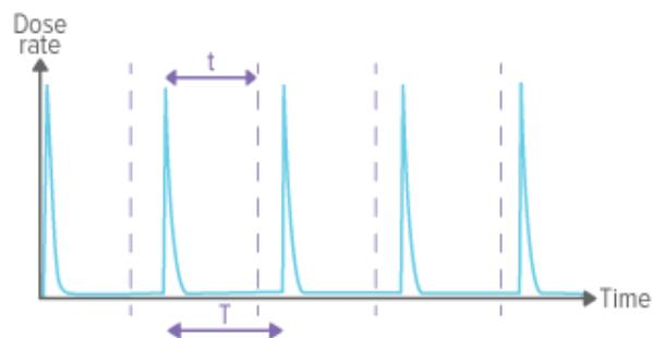
关闭延迟设置 ( $t$ ) 比脉冲间隔时间更短 ( $t < T$ )，将导致许多次短时间的测量（一个脉冲一次）。
