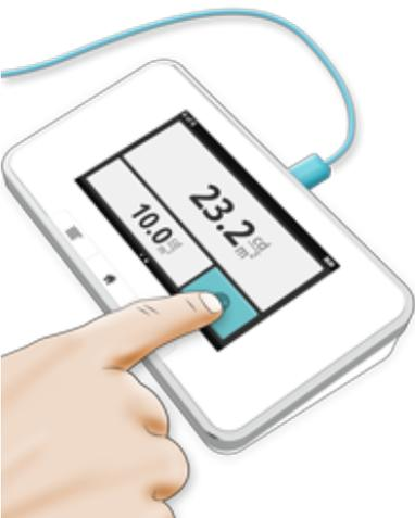
传感器正不断测量中。如果您想要存储某值，当读数稳定时按下按钮。测量将在存储的值的下方继续。
