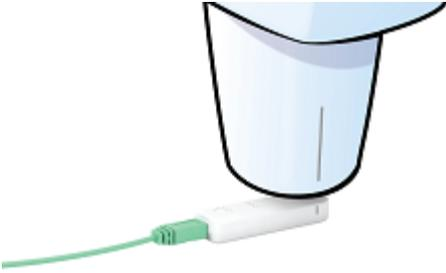
将连接的传感器置于场中央，使十字光标对准 X 射线源。请确保整个传感器矩形位于直接光束之内。
