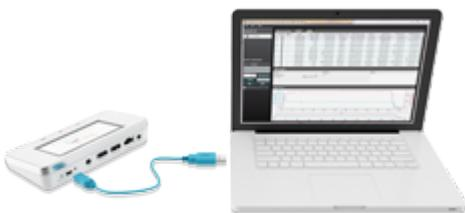
用 USB 数据线（推荐长度：最长 2 米）将主机连接至运行 RaySafe View 的计算机。
