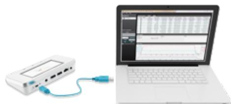
将主机连接到运行 RaySafe View 的计算机上，确保计算机连接至网络。如果有任何可用更新，X2 Online 字段将显示一个通知符号。单击此符号并按照说明升级软件。
