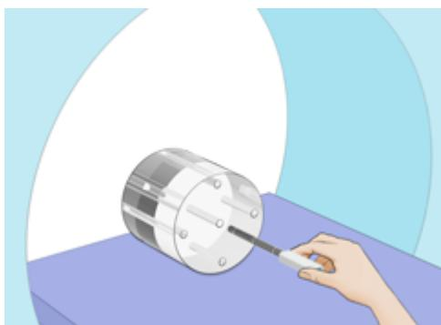
将连接的探头紧推入模体中...
