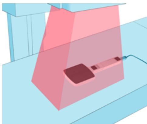
您也可以将探头放在 X 射线辐射场中央，让暗面朝向辐射源，进行低剂量率的测量。
