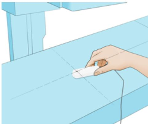
将连接的传感器置于场中央，使十字光标对准 X 射线源。水平面中的传感器视角对测试结果没有影响。
