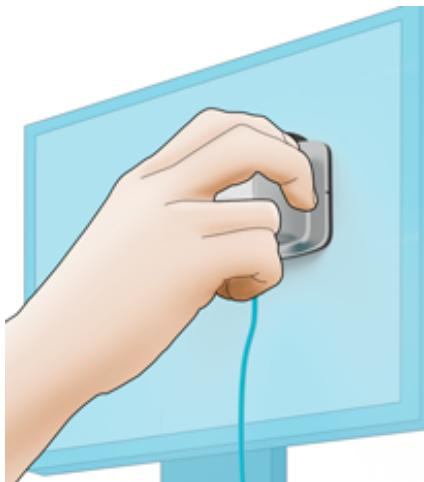
亮度：将孔径置于想要测量区域的中心并在波轮上选择好亮度后放置连接的探头。
