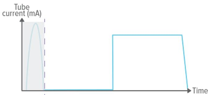
忽略前置脉冲 = 1，(第一个) 前置脉冲得以从测量中排除。
