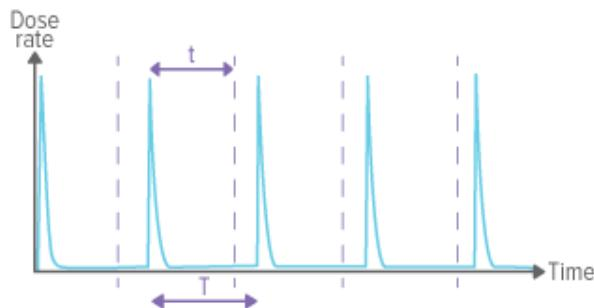
关闭延迟设置比脉冲间隔时间更短 ( $t < T$ )，将导致许多次短时间的测量 (一个脉冲一次)。
