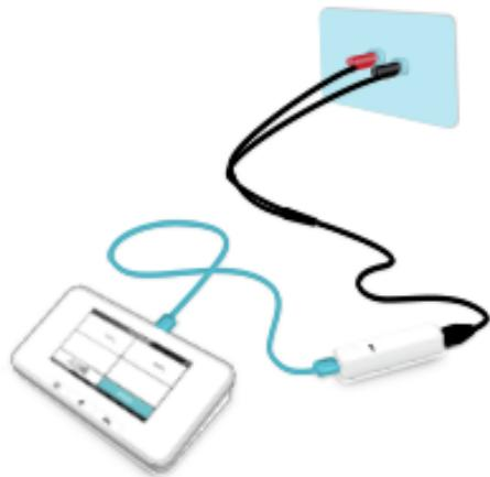
使用专用电压电缆将电压传感器连接至设备。
