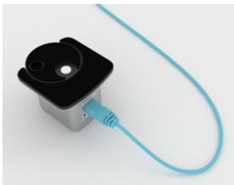
照度：在您想要测量的方向上放置连接的探头，在波轮上选择照度。
