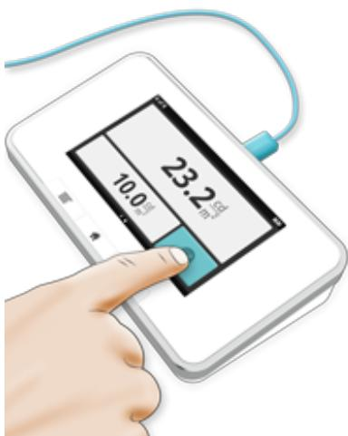
传感器正不断测量中。如果您想要存储某值，当读数稳定时按下按钮。测量将在存储的值的下方继续。
