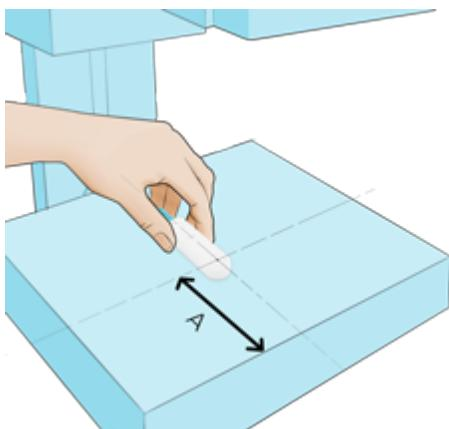
乳腺探头随时可以为所有未更改任何设置的阳极/滤过组合测量剂量和半价层。将连接的探头传感器置于场中央，使十字光标距检查床前边缘 (A) 6 cm (在美国为 4 cm) 处。水平面中的视角对测试结果的影响可以忽略。
