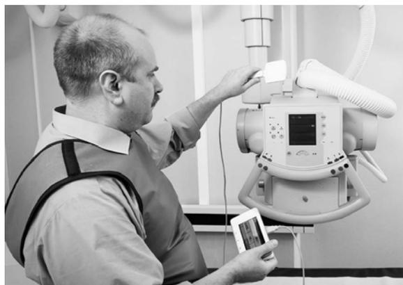
X線管球からの漏洩線を測定中
